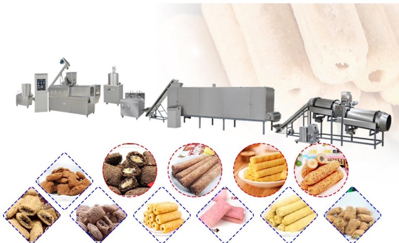
O equipamento de enchimento do núcleo do snack produzido pela Shandong Loyal é composto por misturador de pó, rosca transportadora, extrusora de rosca dupla, máquina de sanduíche, máquina de moldagem, elevador, forno eléctrico, e máquina automática de tempero. Entre eles, o misturador de pó é geralmente utilizado para misturar e preparar vários pós. E também pode ser utilizada para a preparação de matérias-primas. Reduzir o tempo de mistura manual, poupar tempo e esforço.
