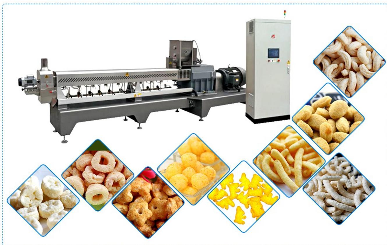
Actualmente, vendemos dois tipos de máquinas extrusoras de parafuso. Uma é uma extrusora de parafuso único. E o outro é uma extrusora de rosca dupla. Em comparação com a primeira, a vantagem da extrusora de rosca dupla é relativamente mais óbvia para a extrusão e expansão de matéria-prima.
