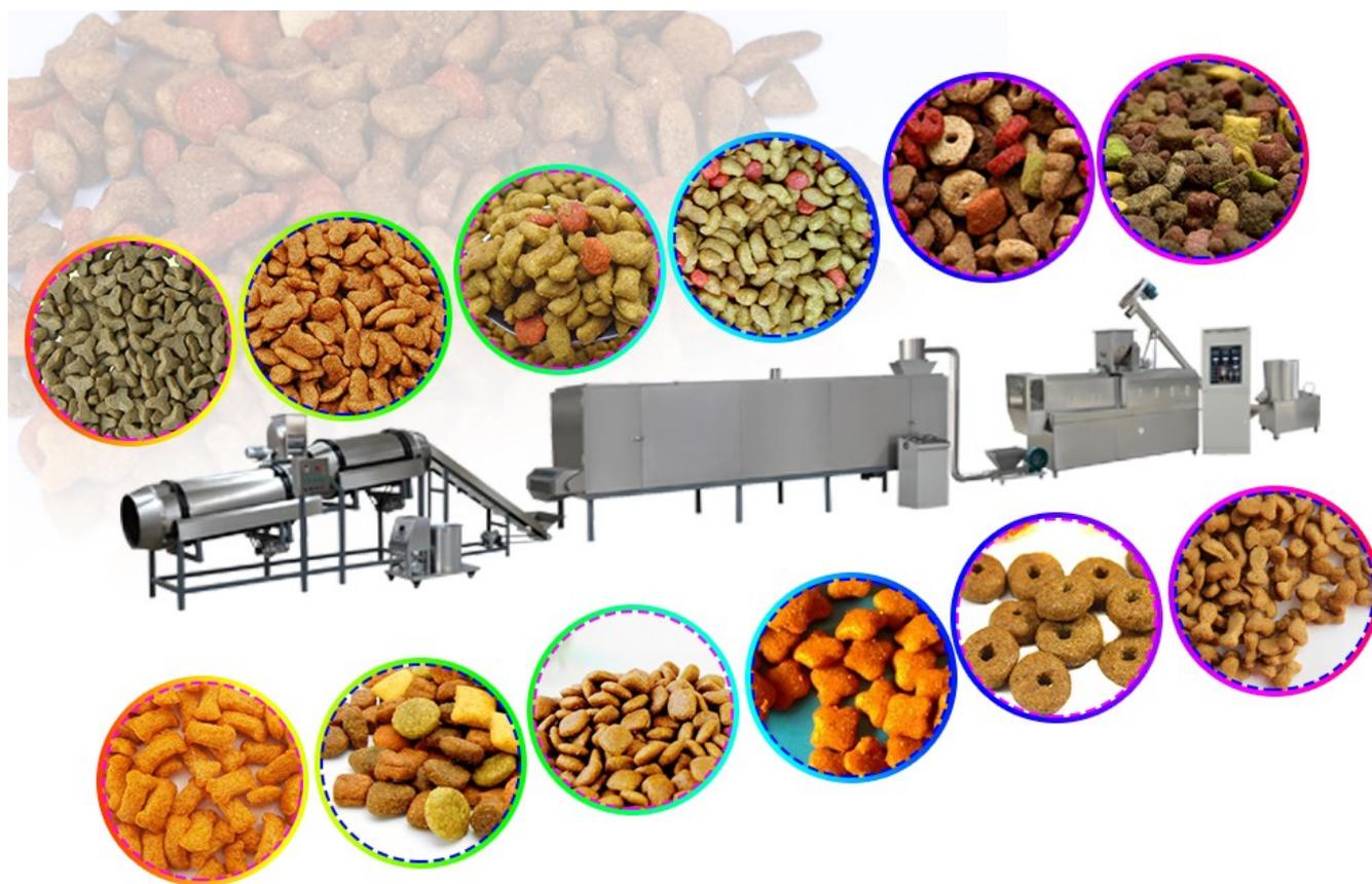
O seu principal princípio de funcionamento é que a energia mecânica é convertida em energia térmica. O calor gerado quando a máquina gira é utilizado para espremer e cozinhar os alimentos. A característica mais óbvia da extrusora de sopro dos alimentos é o seu maior volume.
