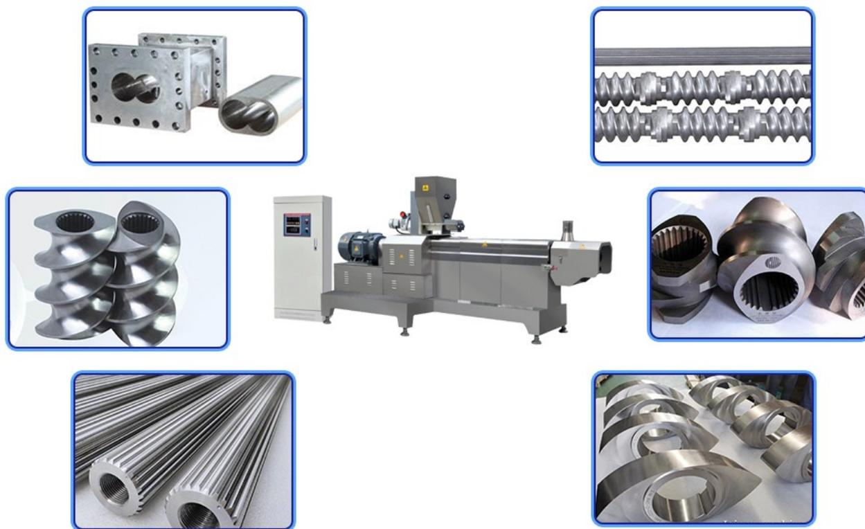
4. Não trazer objectos duros tais como ferro ou pedras para a mini extrusora. Caso contrário, causará danos na espiral e nos pinos de cisalhamento. A entrada da extrusora está equipada com um separador magnético. Mas não pode garantir que todas as peças de ferro serão interceptadas sob o impacto do material. Por conseguinte, no processo de pré-tratamento, deve ser dada atenção à remoção do ferro e da pedra. E o separador magnético deve ser limpo regularmente.
